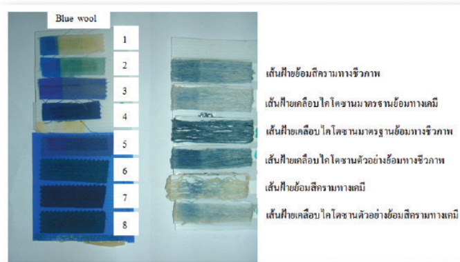
รูปเส้นฟ้ายย้อมคราม ที่ผ่านการทดสอบ ความทนของสีต่อแสงแดด
