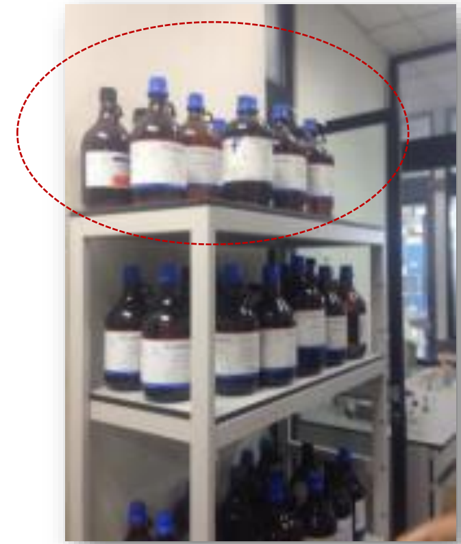
ขวดบรรจุสารเคมีวางไว้บนที่สูงเกินไป
