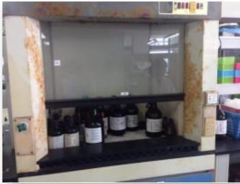
Hood ไม่ใช่ตู้ระเหยสารหรือตู้เก็บสารเคมี
