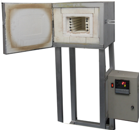
เตาเผาไฟฟ้าสำหรับเผาฟลักสารประกอบเซรามิก Electric Furnace for Sintering Ceramic Compound
