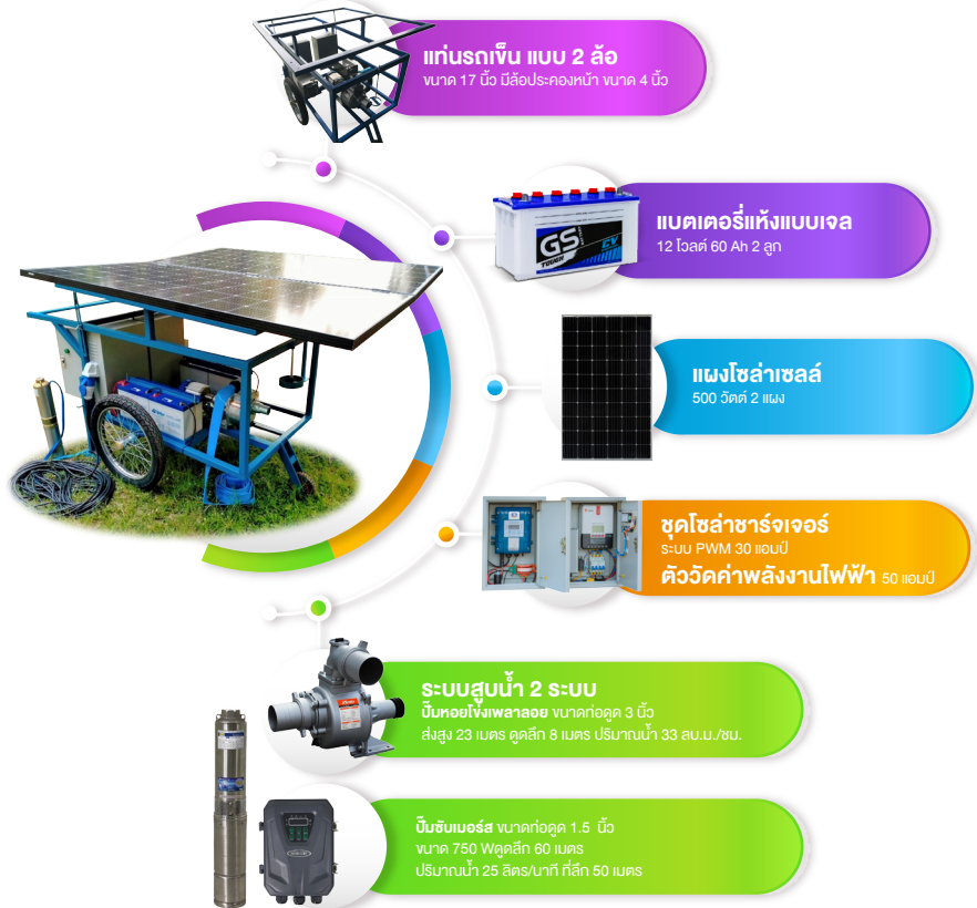
ภาพที่ 4 ส่วนประกอบรถเข็นสูบน้ำพลังงานเซลล์แสงอาทิตย์แบบมัลติฟังก์ชัน
