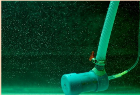
ภาพหัวฉีดฟองอากาศขนาดเล็กจิ๋วและการไหลของเจ็ทน้ำผสมฟองอากาศ รุ่น SNRU-S01 และรุ่น SNRU-V01
