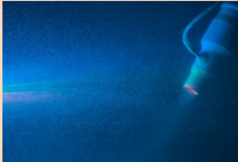
ภาพหัวฉีดฟองอากาศขนาดเล็กจิ๋วและการไหลของเจ็ทน้ำผสมฟองอากาศ รุ่น SNRU-S01 และรุ่น SNRU-V01
